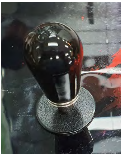
↑ 게임패드 위쪽에서 레버장착 후 톱로즈를 이용하여 하단부 고정클립 장착.
